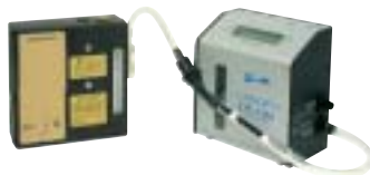
Montage de calibration avec tube inséré dans le support de bas débit
