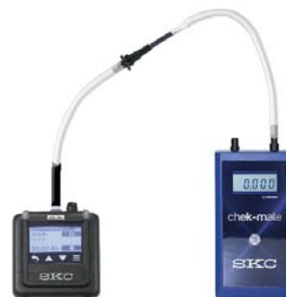
Figure 3. Vue d'ensemble d'une chaîne d'étalonnage à tube unique
