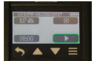
> Touchez le bouton Temps dans le menu de débit pour régler la durée de l'échantillonnage.
