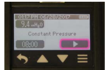
> Touchez le bouton Temps dans le menu avancé pour régler la durée de l'échantillonnage.
